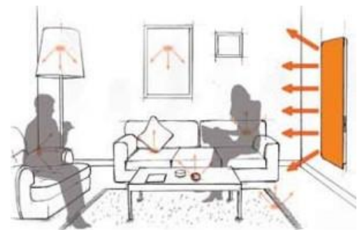
Radiación de calor (calentamiento de la masa)
